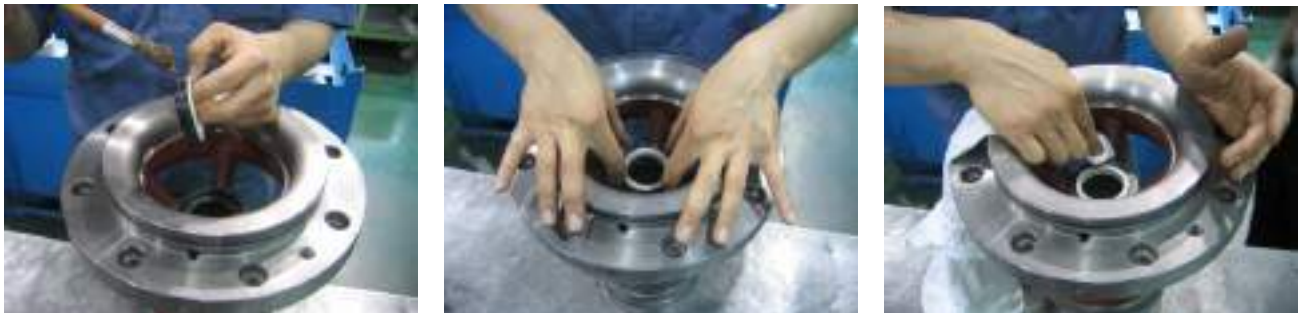
Fig.4 Assembly of seat ring of mechanical seal (메카니칼 씬의 시트링 조립)
