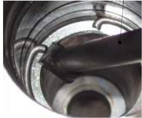
Fig. 2 Dismounting of Locking Ring (Locking Ring의 분해)
