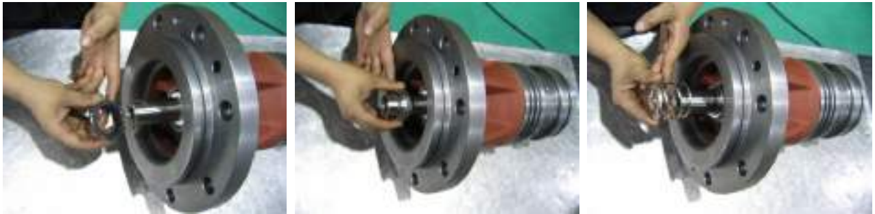
Fig.7 Assembly of rotating part (회전체의 조립)
