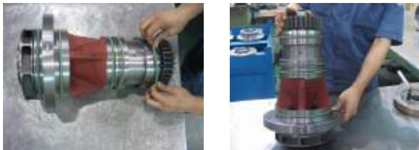
Fig.11 Insertion of O-ring and end products (오링 조립과 완제품)
