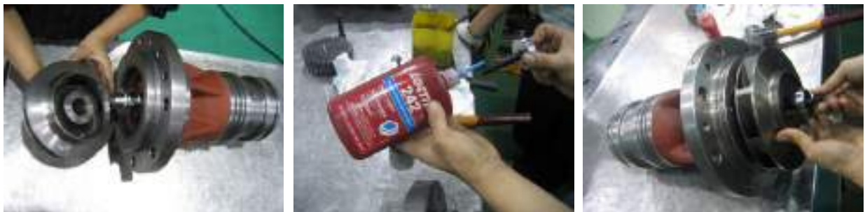
Fig.8 Assembly of impeller and bolt & washer (임펠러, 볼트 그리고 와셔의 조립)
