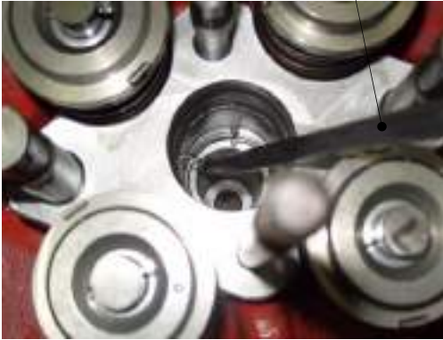
Fig. 1 Locking Ring removal tool (Locking Ring의 분해 공구)
