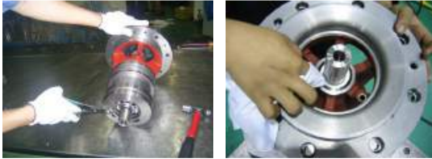
Fig.6 Assembly of snap ring into pump housing (펌프 하우징에 스냅 링 조립)
