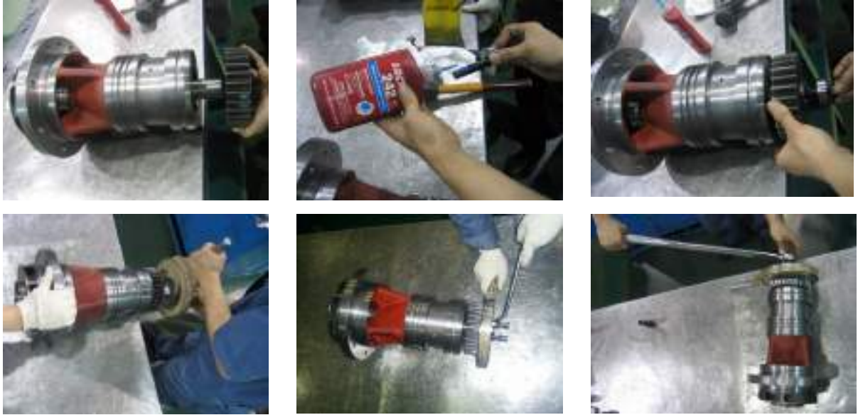
Fig.9 Assembly of spur gear and bolt & washer (스피어 기어, 볼트 그리고 와셔의 조립)
