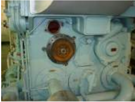
Fig.12 Assembly of C.W.Pump housing(청수 펌프 하우징 조립)
