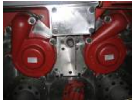
Fig.13 Assembly of C.W.Pump cover and the assembled C.W.Pump (청수 펌프 커버 조립과 청수 펌프 조립완료된 상태)
