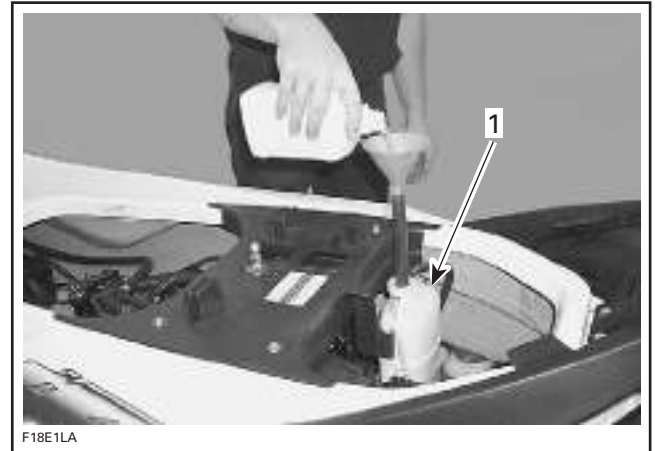
1. Pour antifreeze/water mix in expansion tank
