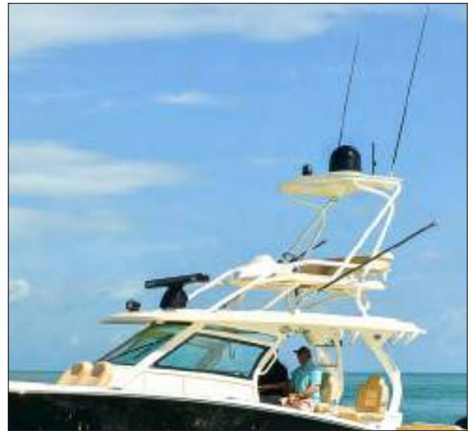
Upper Helm Flybridge
