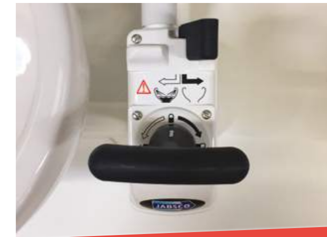
5 WC lever into position « water intake »
