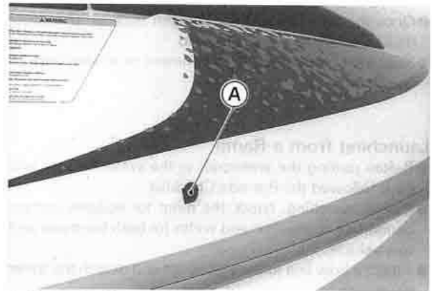
A. Bypass Outlet
