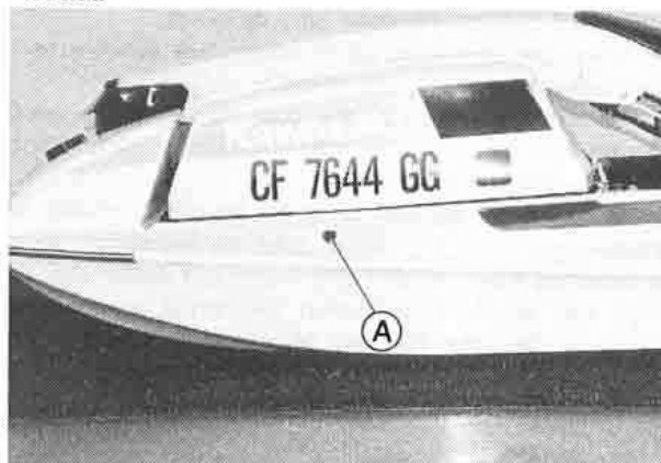
A. Bypass Outlet
