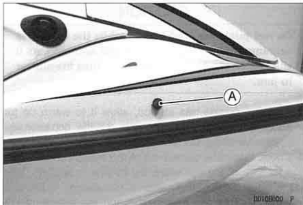
A. Bypass Outlet
