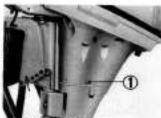
① Engine oil drain screw ① Vis de vidange de l'huile moteur
