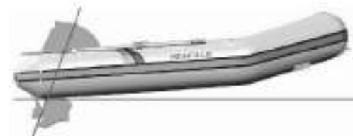
L'avant du bateau déjauge, trop de trim positif
