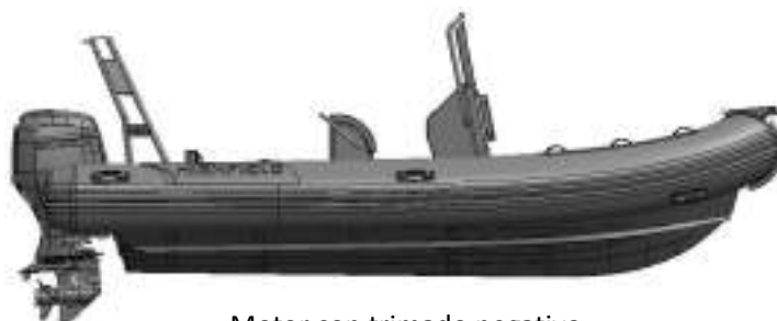
Motor con trimado negativo
