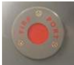
Feuerlöschöffnung auf der Backbordseite der Konsole
