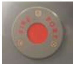
Feuerlöschöffnung auf der Backbordseite der Konsole
