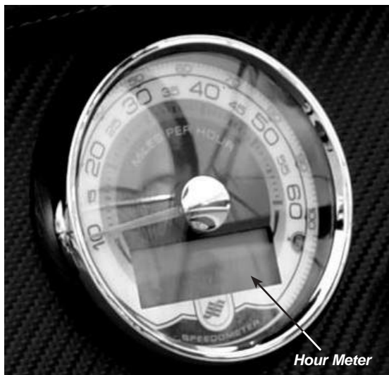
Figure E12: Hour Meter
