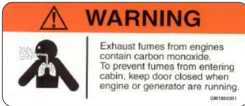
A. Carbon Monoxide - Cabin Door Warning Label
